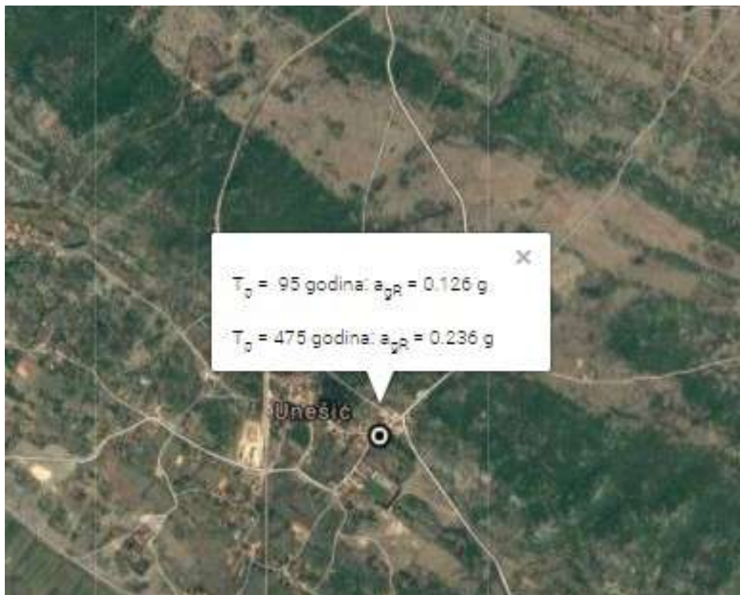
Slika 6. Iznosi vršnih ubrzanja tla za povratna razdoblja 95 i 475 godina
